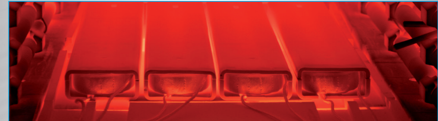
Burn-in-Test der Sensorenspulen im dafür konzipierten Ofen bei EMG
